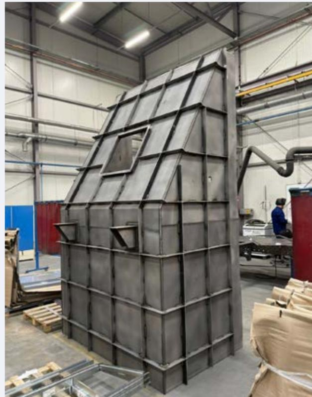
Einfüllbehälter mit Auflagekonsolen und Verstärkungsrippen.
