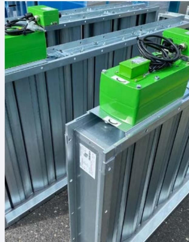
Ansaugereinheit bestehend aus Sandabscheider, Schalldämpfer und Jalousieklappe.
